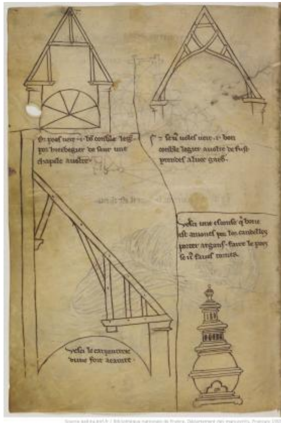
Modèles de charpente et lanterne sourde, Carnet de Villard de Honnecourt, France, XIIIe siècle, BnF, Fr. 19093, fol. 34. Source : Wikimedia Commons.
