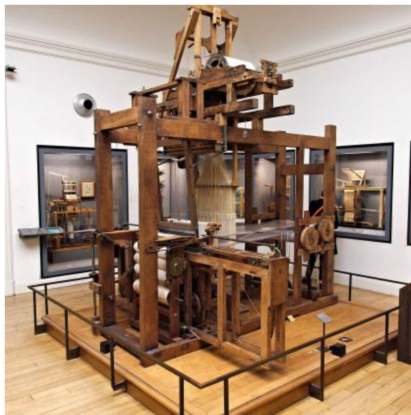
Jacques Vaucanson, Métier à tisser les étoffes façonnées de Vaucanson destiné à remplacer l'ancien métier à la tire (1746). Musée des arts et métiers.
