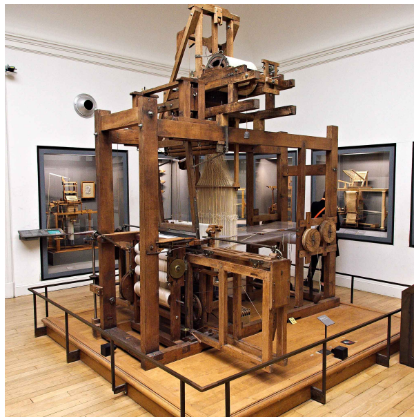
Jacques Vaucanson, Métier à tisser les étoffes façonnées de Vaucanson destiné à remplacer l'ancien métier à la tire (1746). Musée des arts et métiers. Photographie Frédéric Bisson. Source : www.flickr.com
