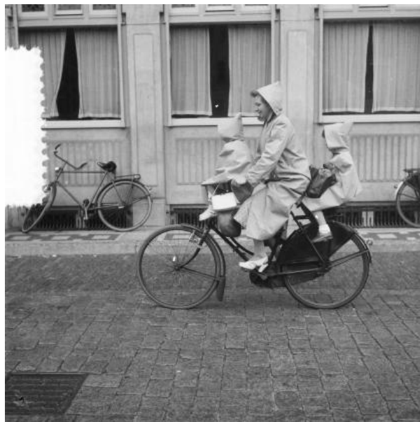
Femme à bicyclette sous la pluie (lieu inconnu, 7 août 1952). Elle transporte deux de ses enfants. On aperçoit le garde-boue fermé couvrant les roues, notamment la roue arrière, le couvre-chaîne fermé, ainsi que deux porte-bagages, à l'avant et à l'arrière, un pour chaque enfant.
