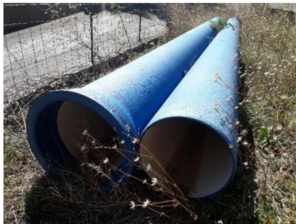
Illustration 1 : Tuyaux Saint-Gobain PAM (nom de l'entreprise Pont-à-Mousson depuis 2000) NATURAL BioZinalium® (revêtement composé d'un alliage de zinc-aluminium enrichi en cuivre) à emboîtement standard de diamètre nominal 350 mm (revêtement intérieur : mortier de ciment centrifugé ; revêtement extérieur : ©BioZinalium et peinture). Source : Photographie de Carole Lamoureux, 2020.
